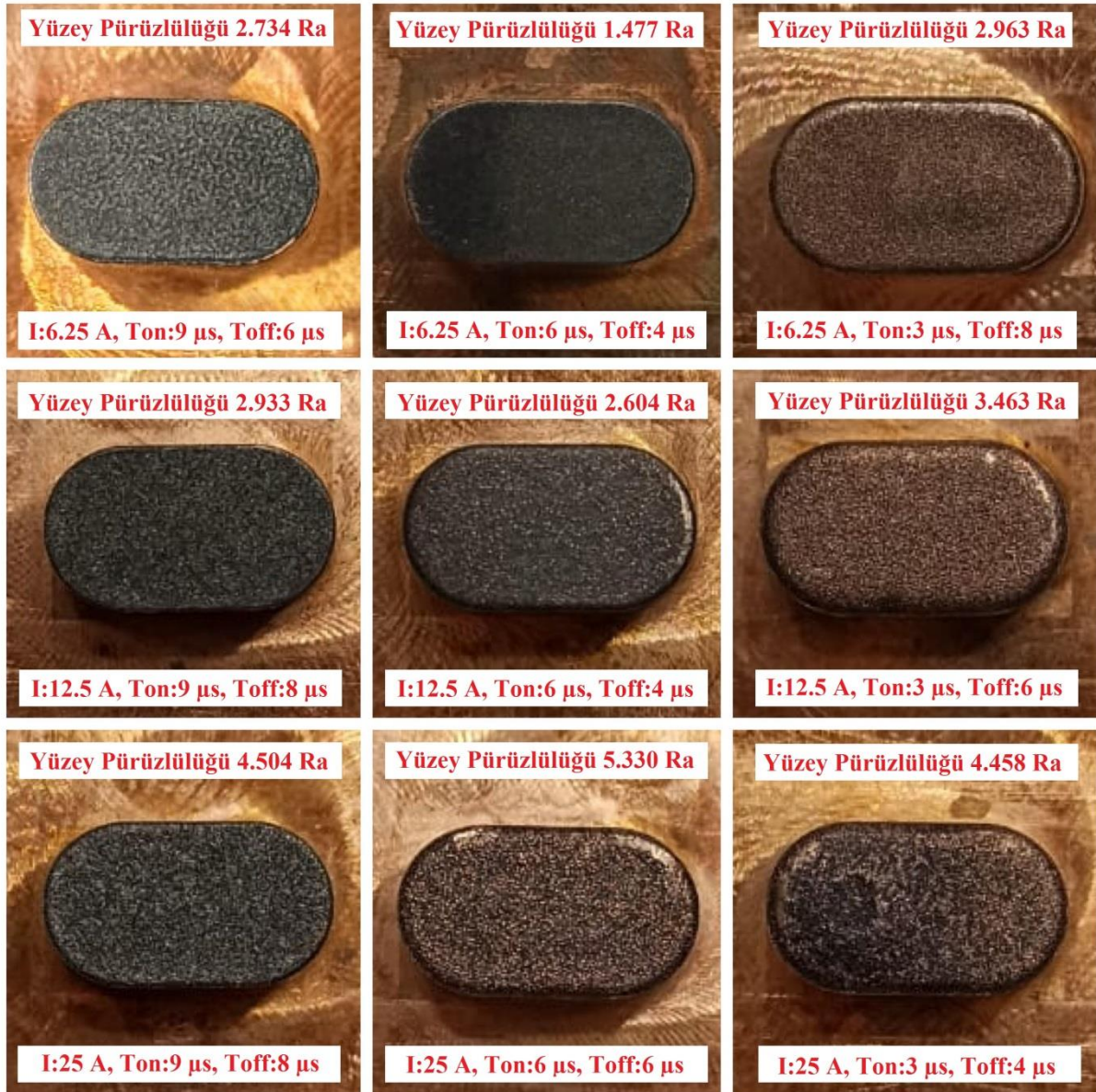
Şekil 6. Bakır elektrotların optik mikroskop görüntüleri (x5 büyütme oranı)
