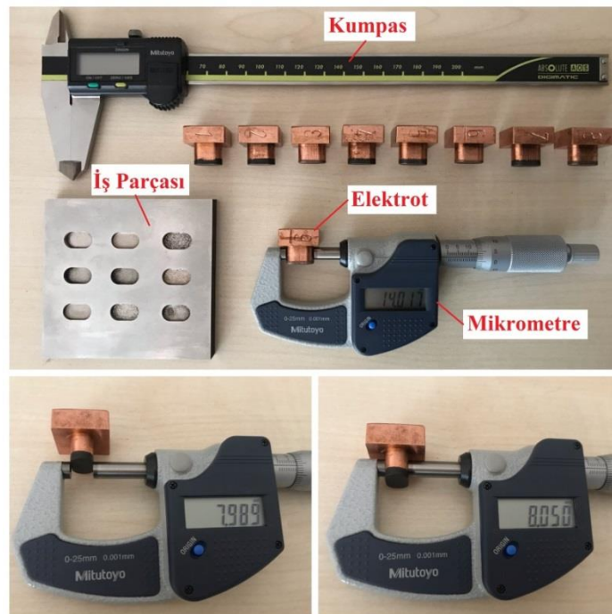
Şekil 5. Mitutoyo mikrometre ile elektrot ölçümü
