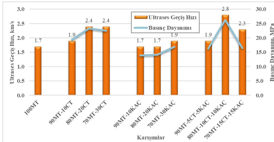
Şekil 6. Harçların Ultrases Geçiş Hızı-Basınç Dayanımı Değişimi (Variation Between Ultrasonic Pulse Velocity-Compressive Strength of Mortars)
