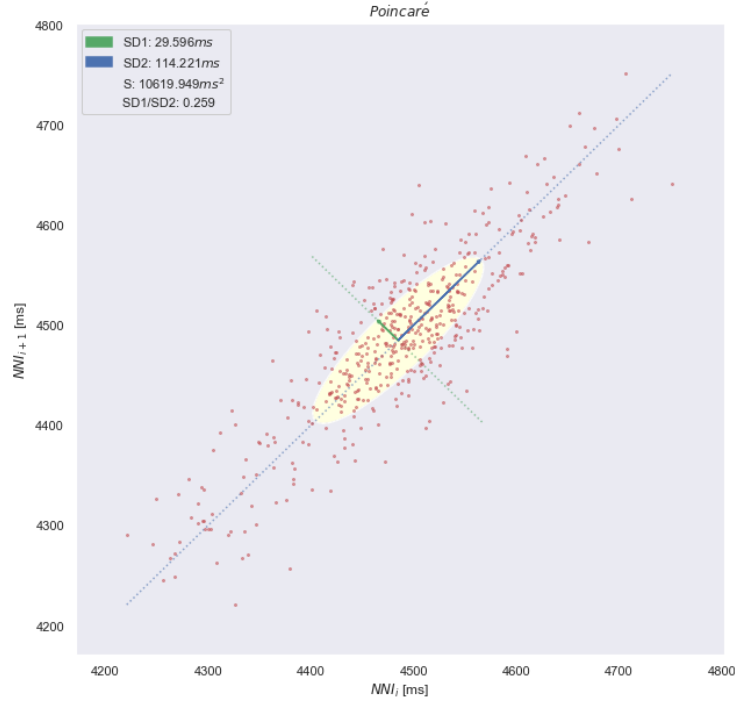
Şekil 1. Veri setindeki simulationRun=1, faultNumber=1 için xmeas_3 değerine ait Poincaré çizimi ve SD1-SD2 değerleri
