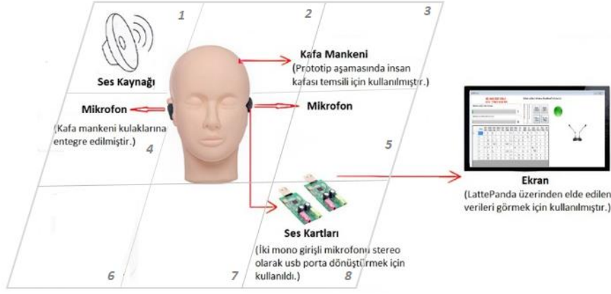
Şekil 2. Tasarlanan sistem prototip şeması
