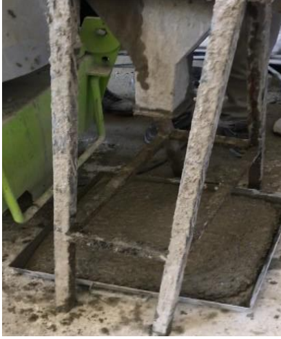
Şekil 4. V hunisi deneyi.
