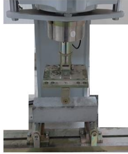
Şekil 5. Basınç dayanımı deneyi.
