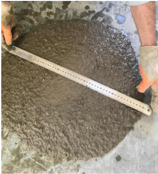
Şekil 2. Yayılma tablası deneyi.
