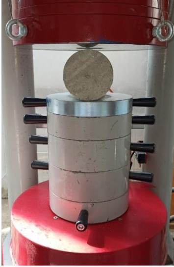
Şekil 7. Yarmada çekme deneyi.
