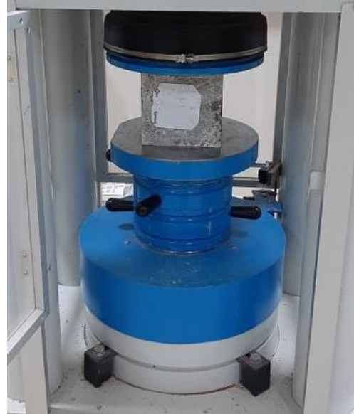
Şekil 6. Eğilmede çekme deneyi.
