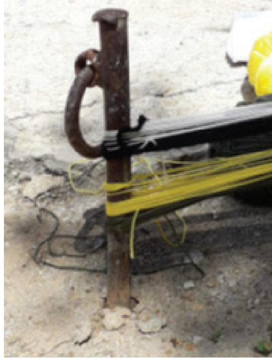
Fotoğraf 4: Demir Çubuk, Kolan Dokuma Tezgâhı
