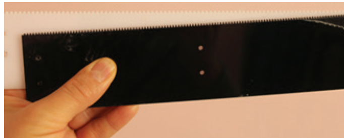
Fotoğraf 19: Çözgü sıklığını belirleyen düzenleyici taraklar
