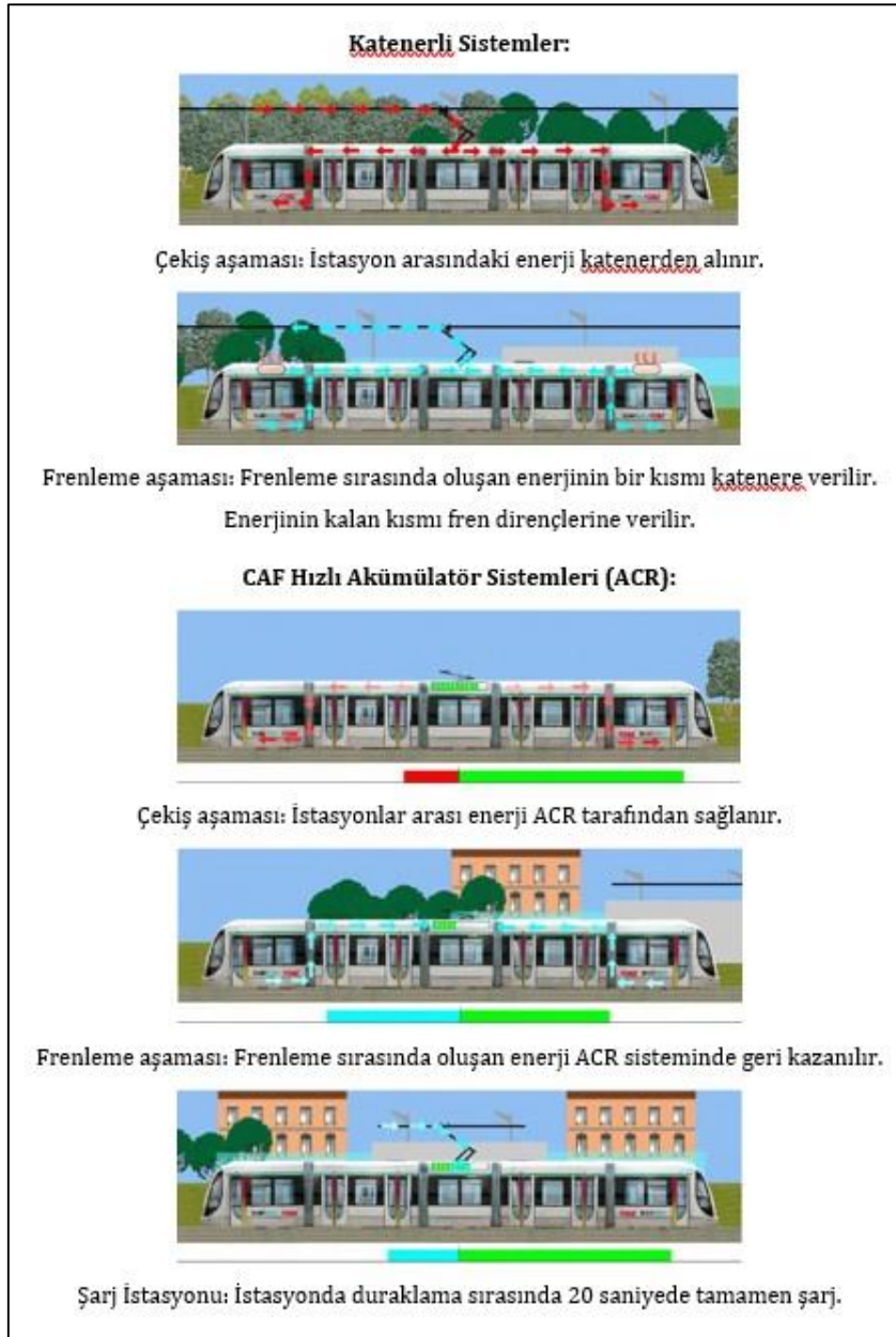
Şekil 8. Katenerli ve CAF Katenersiz Aracının Çalışma Gösterimi (CAF, 2020)
