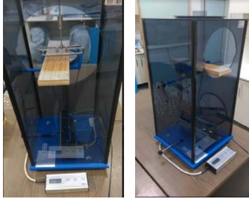
Şekil 4. Pandüllü sertlik cihazı ve sertlik deneyi
