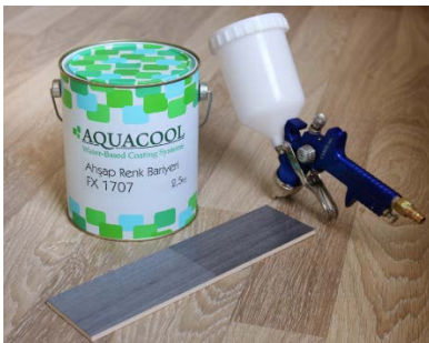
Şekil 1. Deneme örneği, astar koruma bariyeri ve üstten depolu vernik tabancası
