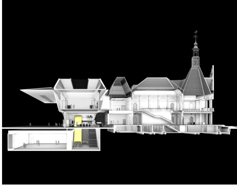
Şekil 12- Müzenin Museumplein'a doğru uzanan, toprak altındaki Avrupa'nın en büyük açıklığına sahip sergi alanını gösteren kesit (URL-5).
