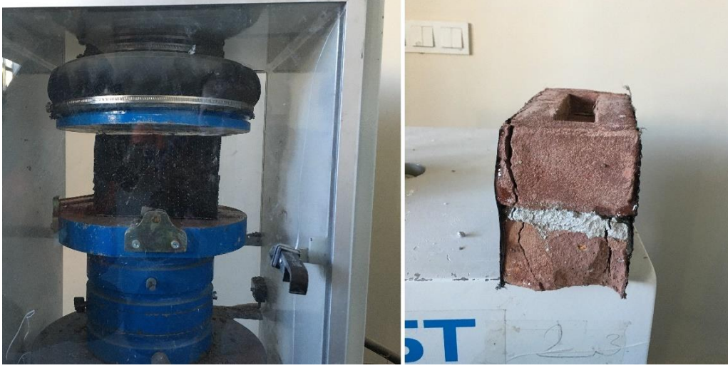
Şekil 11. CFRP kumaşla güçlendirilmiş numunelerin basınç deneyinin gerçekleştirilmesi
