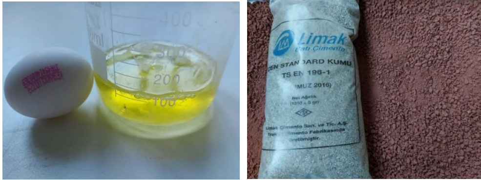
Şekil 1. Horasan harcı karışımında kullanılan yumurta akı, standart kum ve tuğla kırığı görüntüleri
