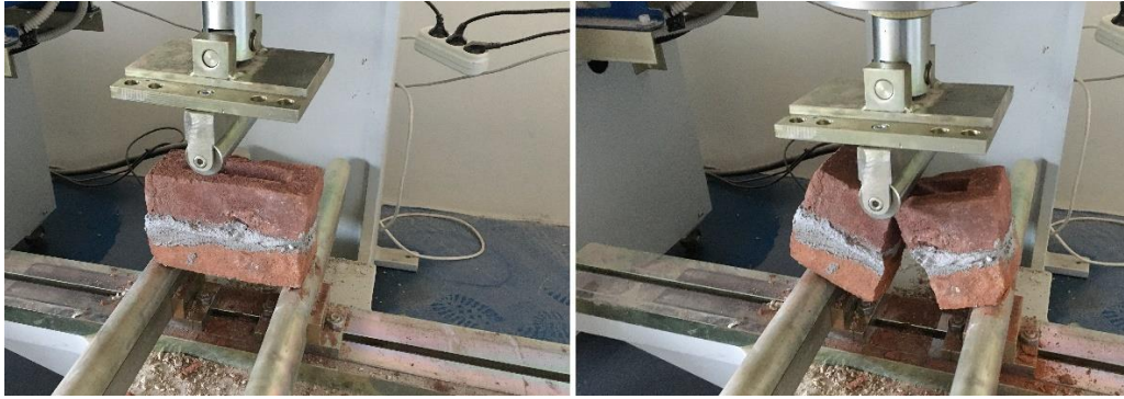
Şekil 10. Şahit numunenin 3-noktalı eğilme deneyinin gerçekleştirilmesi
