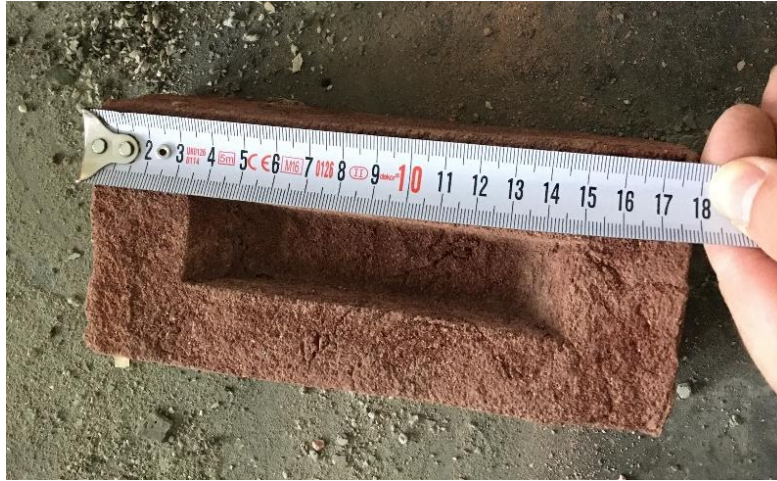
Şekil 4. Çalışmada kullanılan dolu harman tuğlası
