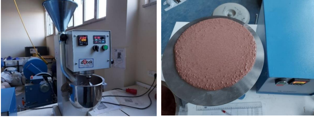
Şekil 2. Horasan harcının mikserde karıştırılma aşaması ve kıvam deneyi görüntüleri
