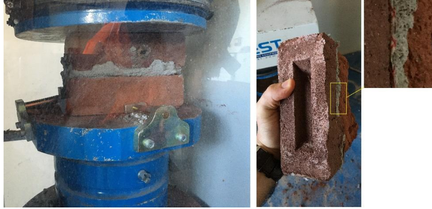
Şekil 13. Murfor® yatay derz donatısı ile güçlendirilmiş numunelerin basınç deneyinin gerçekleştirilmesi
