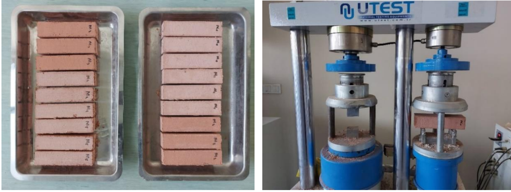
Şekil 3. Horasan harcı örnekleri ve eğilme dayanım deneyi
