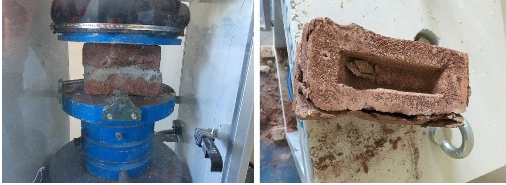
Şekil 9. Şahit numunenin basınç deneyinin gerçekleştirilmesi
