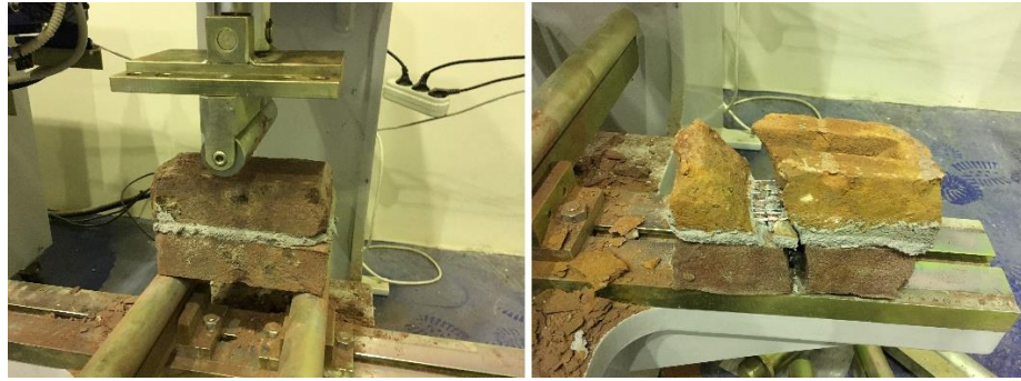
Şekil 14. Murfor® yatay derz donatısı ile güçlendirilmiş numunelerin 3-noktalı eğilme deneyinin gerçekleştirilmesi
