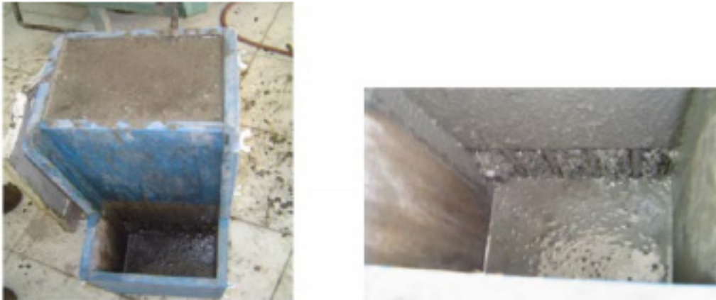
Şekil 5. Çelik lifli numunelerde U-Kutusu Deneyi Sırasında Liflerden Dolayı Donatılar Arasında Tıkanma Oluşması. (Yıldırım, Sertbaş & Berbergil, 2007).
