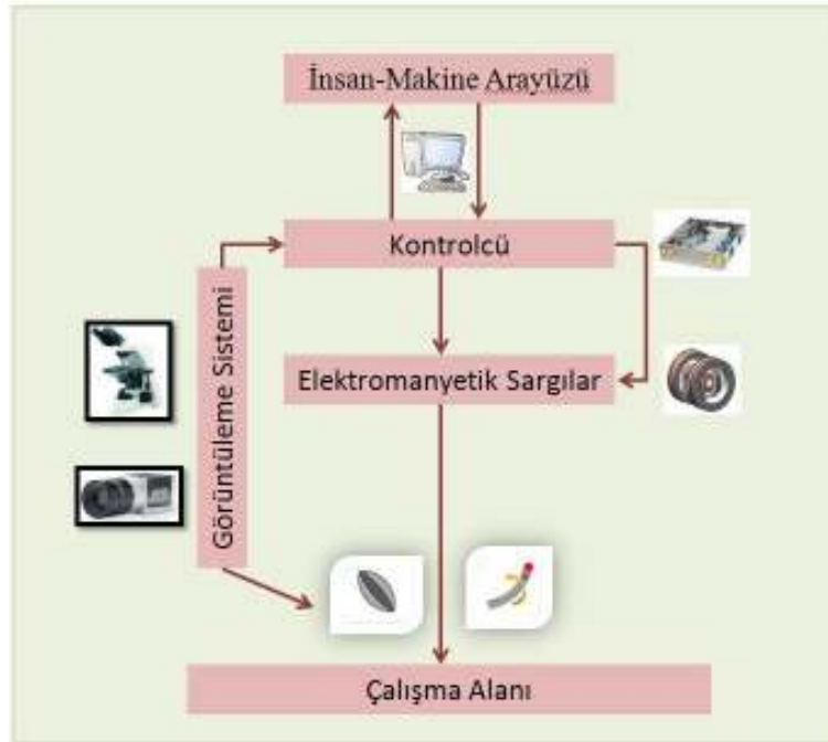
Şekil 3. Elektromanyetik aktüatör sistemi (elektromanyetik sargılar, kontrolcü, görüntüleme sistemi ve insan-makine arayüzü) ile mikrorobot kontrolünün gösterilmesi
