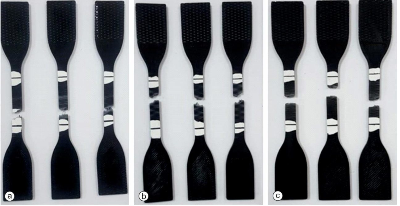
Şekil 5. ABS materyali ile baskısı alınan numunelerin çekme mukavemeti deneyi sonrası görüntüleri doluluk oranlarına göre (a) %20, (b) %40 ve (c) %60
