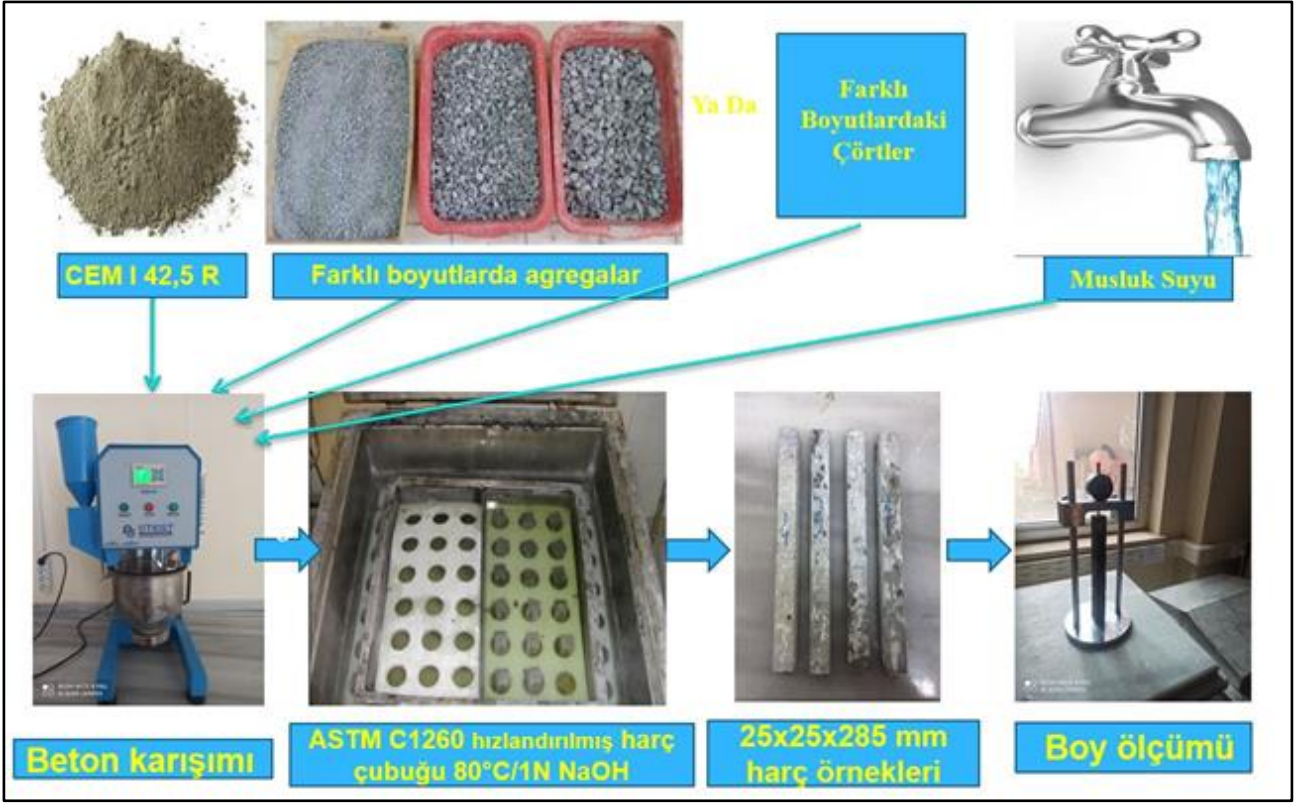
Şekil 2. Hızlandırılmış harç çubuğu deney aşamaları
