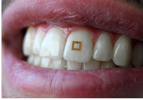
Şekil 2. Glikoz-Tükürük Algılama Cihazı (21)
