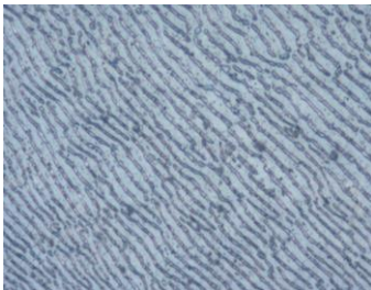
Şekil 5. %0.1 Sr içeren galfan mikro yapısı
