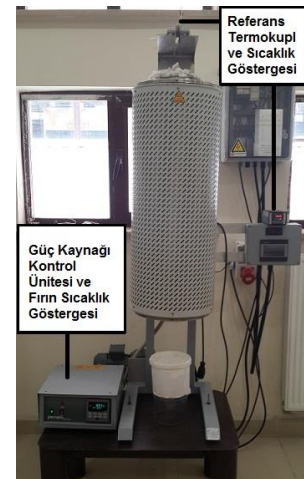
Şekil 5. SKSFS işlemi deney düzeneği (SLPS process test setup)
