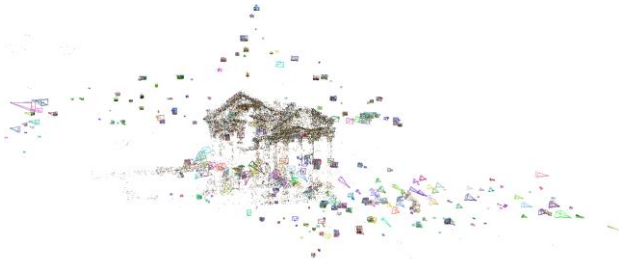
Şekil 5. Seyrek nokta bulutu, kamera konumları ve yönleri.
