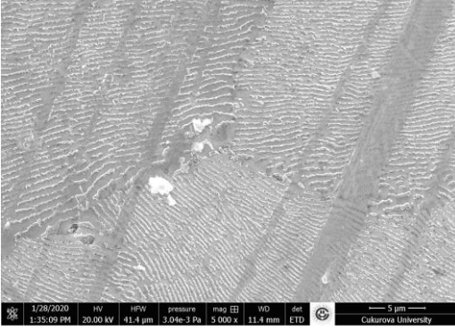
Şekil 9. %0,1 Sr içeren suda soğutulmuş galfan mikro yapısı
