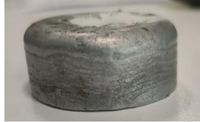
Şekil 3 : Dökümü alınan 403*202 mm boyutundaki silindirik numune.
