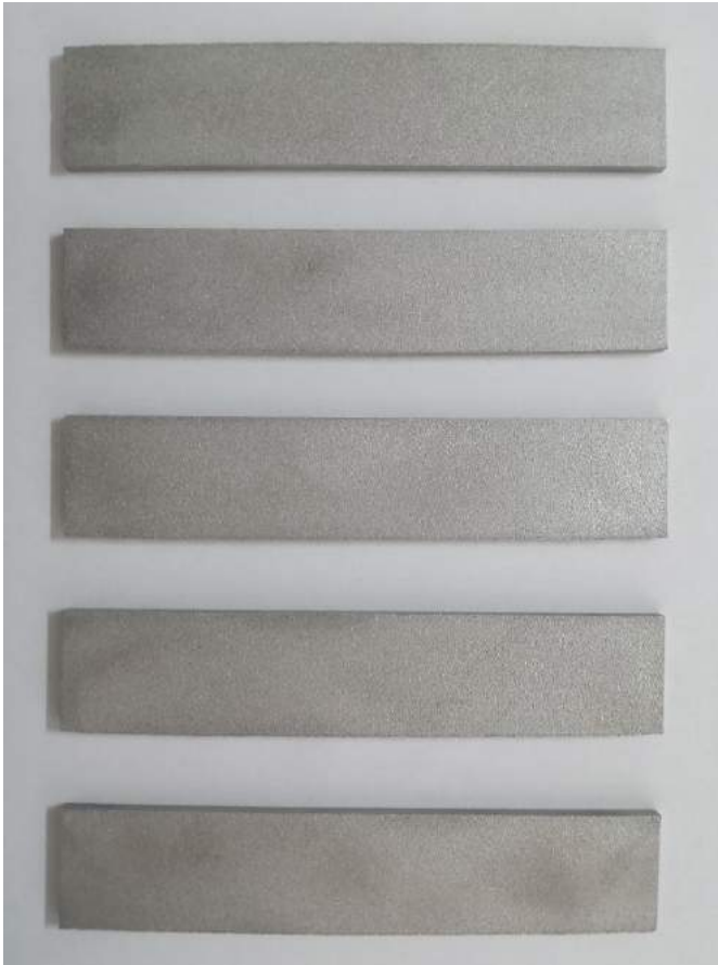
Şekil 2. Eklemeli imalatla üretilen AlSi10Mg alaşımları
