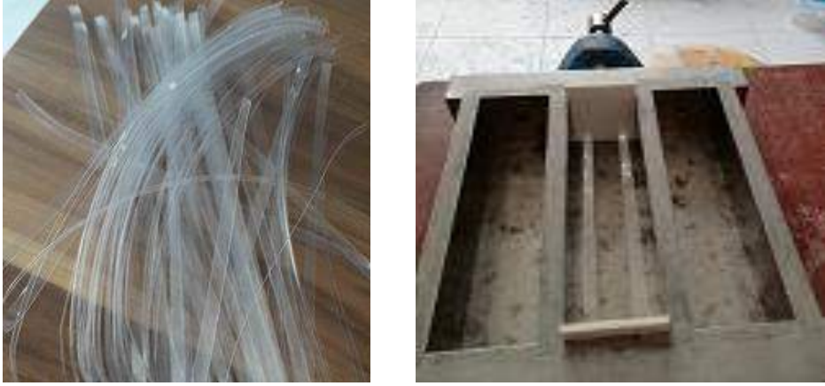
Şekil 1. Hazırlanan Pet Atıkları ve Kalıp İçinde Yerleşimi
