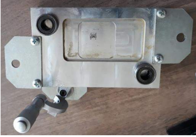
Şekil 7. Ön Denemelerde Kullanılan 3D Metal Baskı İçin Hazırlanan Manuel Toz Yatağı
