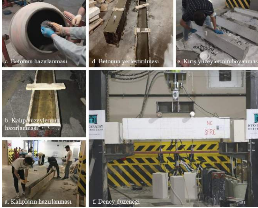
Şekil 3. Deney numunelerinin test için hazırlanması
