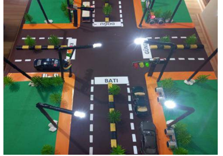
Şekil 12: Akıllı kavşak sisteminde üç yöndeki trafik yoğunluğuna bağlı sinyalizasyon sistemi tepkisinin görünümü
