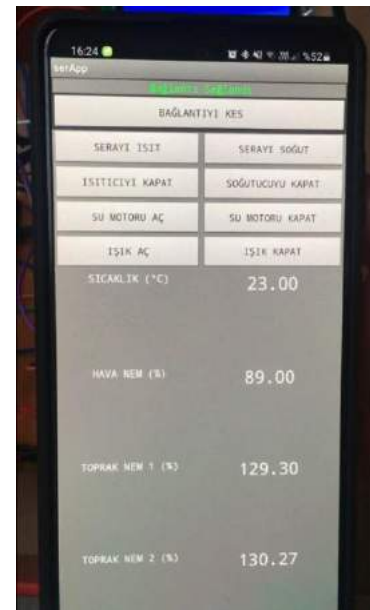
Şekil 3 Bağlantı sağlandıktan sonra verilerin okunarak uygulamada gösterilmesi
