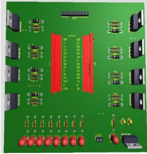
Şekil 2. Yapay Zekâ Destekli Gömülü Sisteme Devre Tasarımı (Üst Görünüm) – Wi-Fi
