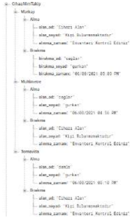
Şekil 2. Veritabanına ait ‘parent-child’ yapısı
