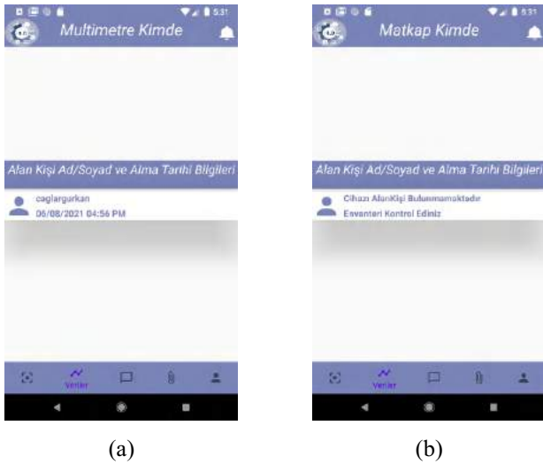
Şekil 8. (a) Cihaz herhangi bir kişideyken elde edilen sonuçlar ve arayüz tasarımı, (b) Cihaz herhangi bir kişide değilken elde edilen sonuçlar ve arayüz tasarımı
