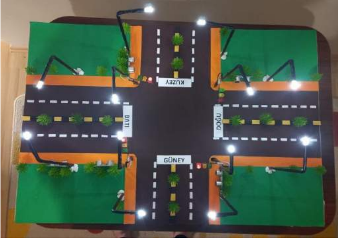
Şekil 7: Akıllı kavşak sisteminin uygulama maketi görünümü
