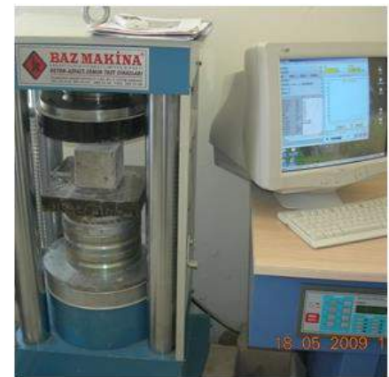
Şekil 2.4 BAZ marka (200ton) beton pres makinesi
