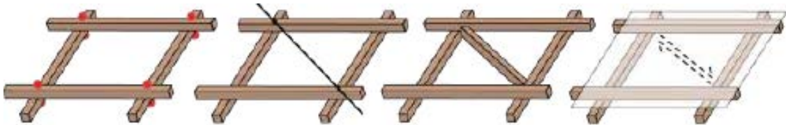
Şekil 3: a) Rijit birleşimler b) çapraz çelik kablolar c) rijit (ahşap) çapraz destek d) rijit kaplama Şekil 3. Bağlantı destek elemanları (Naicu, 2012, s. 22).
