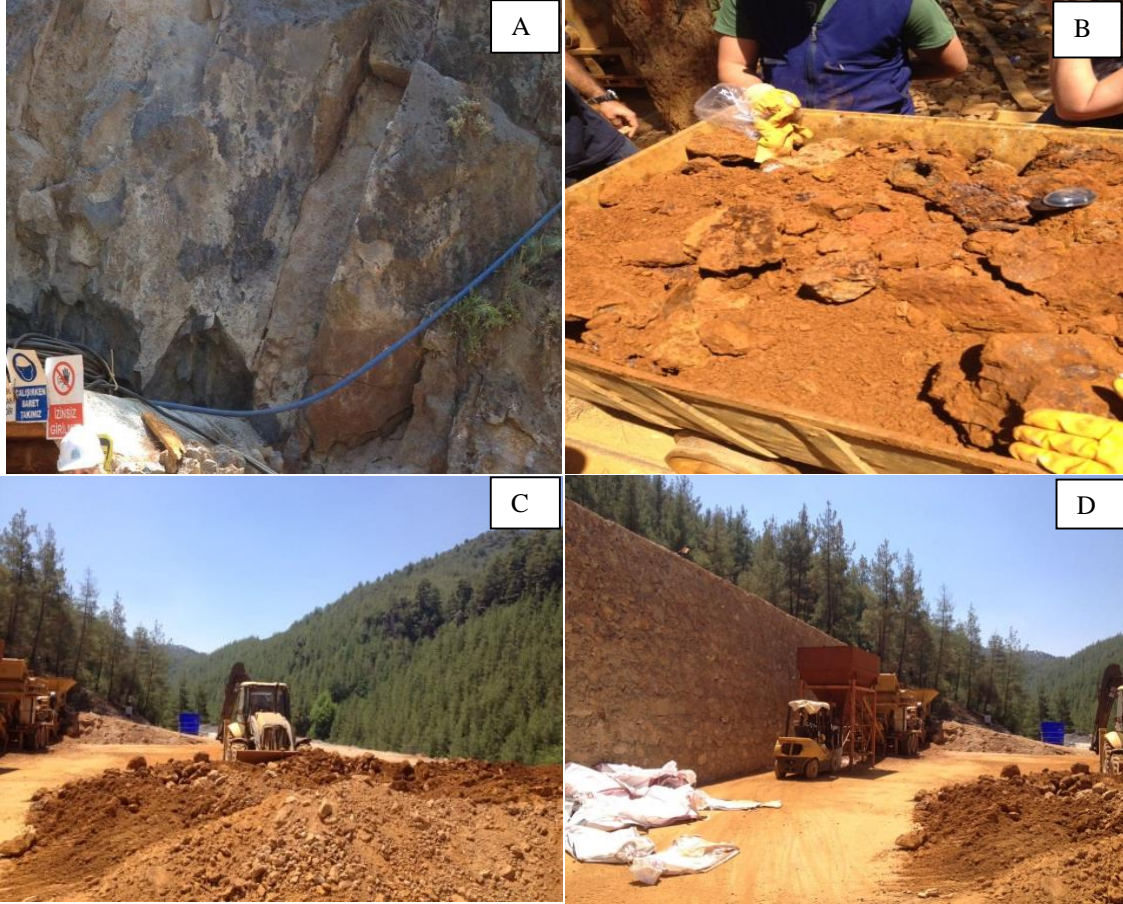
Şekil 2. A) Yankayaç (Emirgazi fm. ait kireçtaşı), B) Yeraltı galerisinden çıkan cevher ve yankayaç örnekleri, C) Cevher ve yankayaçların galeri ağızı biriktirildiği alan, D) Stok alanı genel görünümü
