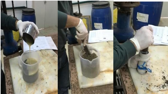
Şekil 4. Numune karıştırma işlemi ve standart basınç deney numuneleri hazırlanması
