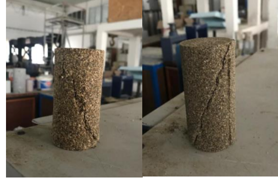
Şekil 11. Standart basınç testi kırılma şekilleri
