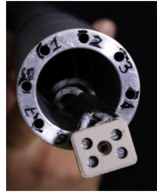
Şekil 3. Deney silindirinin (a), ve ısıl eleman çiftlerinin yerleştirilmiş halinin (b) resmi
