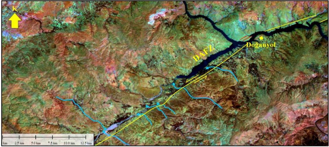
Şekil 5. RGB: 521 bant kombinasyonu ve kenar gemesi uygulanmış ASTER uydu görüntüsü, yorumlanmış görünümü (DAFZ: Doğu Anadolu Fay Zonu, sarı çizgiler ana fay zonunu, kırmızı çizgiler faya paralel gelişmiş basınç sırtlarının eksenlerini, mavi çizgiler ise ötelenmiş akarsuları göstermektedir)
