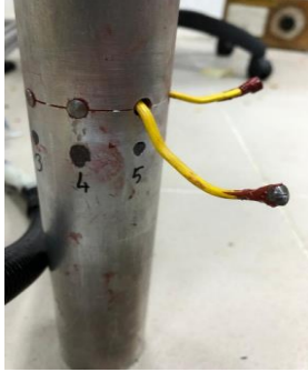
Şekil 4. Silindirin yüzeyinde oluşturulan ölçüm noktalarının resmi
