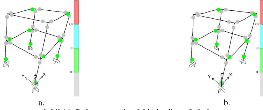
Şekil 11. Dokuzuncu adımdaki plastik mafsallı oluşumu
