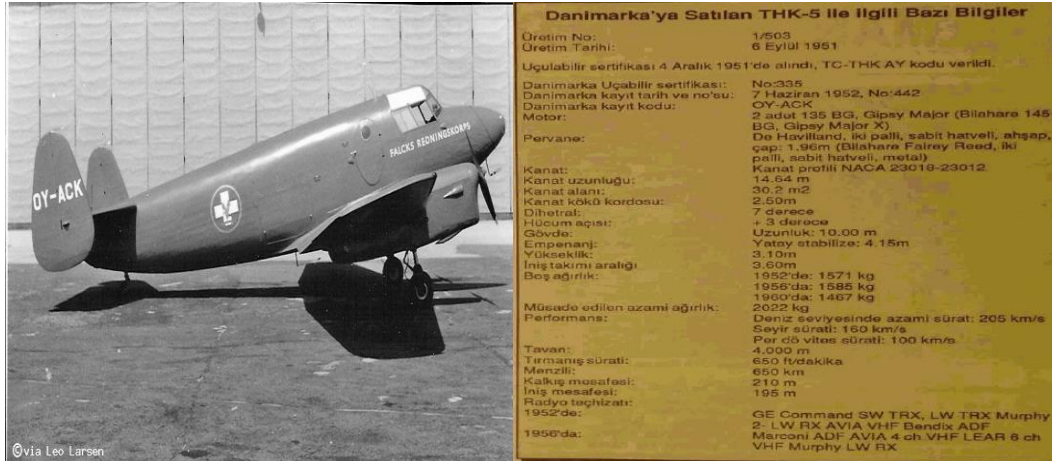
Resim 2: THK-5A (TC-THK AY) Ambulans Uçak ve Teknik Özellikleri
