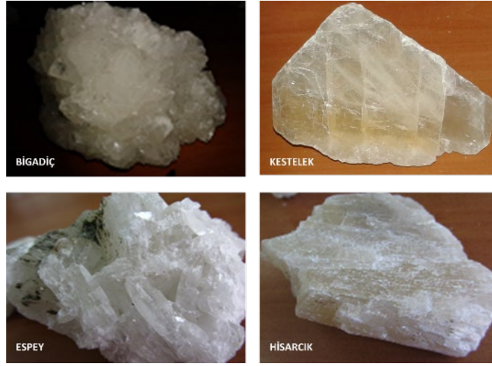
Şekil 3. Bigadiç, Kestelek, Espey ve Hisarcık yörelerinden temin edilen deneysel çalışmalarda kullanılan kolemanit kristalleri.
