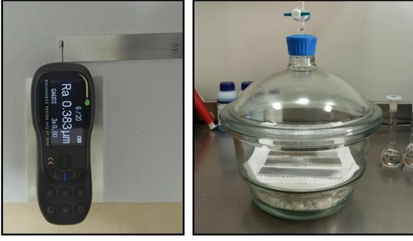
Şekil 3. Pürüzlülük ölçümü ve numunelerin muhafaza edilmesi
