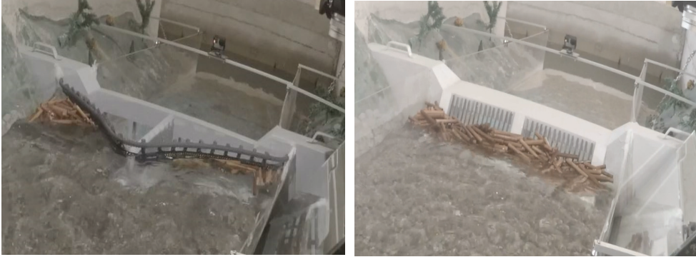
Şekil 12 - Gemiburnu tip geçirgen bent ile YG2 bendin ön cephede odunsu malzeme birikim ve blokaj durumları
