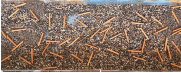
Şekil 7 - Odun malzemesinin kanal hareketli yatağına yerleştirilmesi
