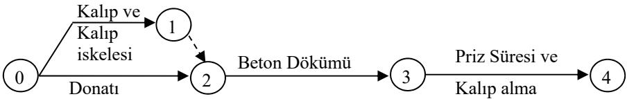
Şekil 1 - Bir kat kaba inşaatının ok şebeke diyagramının gösterimi
