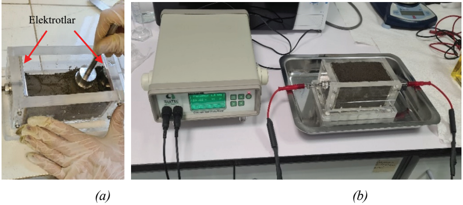
Şekil 3 - Elektrik iletkenliği deneyi: (a) Numune hazırlanışı, (b) Elektrik rezistansı ölçümü
