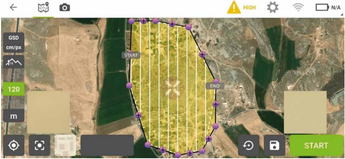
Şekil 5. Fotogrametrik uçuş planı / Photogrammetric flight plan
