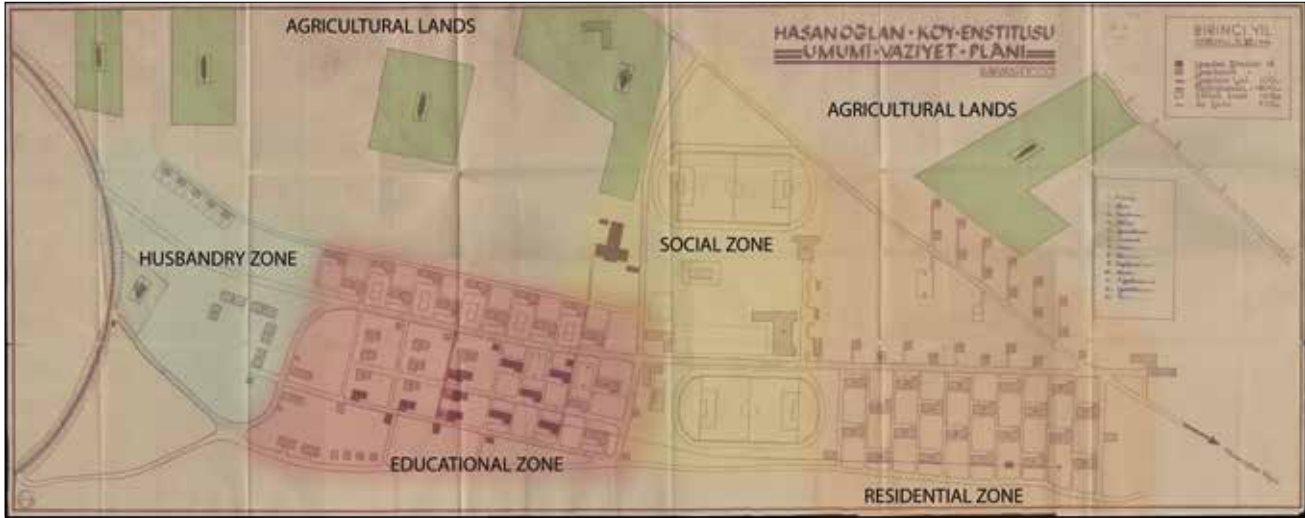
Figure 10: Site plan of the winning project (colored by the author based on archive documents obtained from IHTBV; yellow: social zone, red: educational zone, orange: residential zone, blue: husbandry zone and green: agricultural zone). / Kazanan mimari projenin vaziyet planı (IHTBV'ndan elde edilen arşiv dokümanlarına göre yazar tarafından renklendirilmiştir; sarı: sosyal alan, kırmızı: eğitim alanı, turuncu: konaklama alanı, mavi: hayvancılık alanı ve yeşil: tarım alanı)
