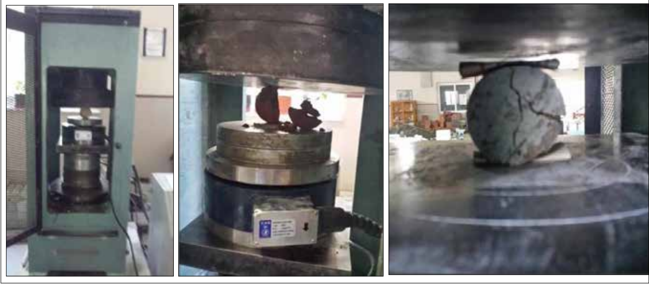
Levha 6: Numunelere yarmada çekme testi yapılması. / Splitting tensile test on the samples.
