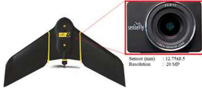
Şekil 2. ebee sensefly plus sabit kanatlı İHA ve S.O.D.A kamera
