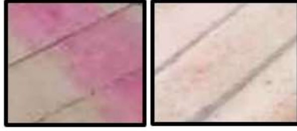
řekil 9. Rhodamine-B ile yapılan alıřmada UV ışık altında meydana gelen renk aılması
