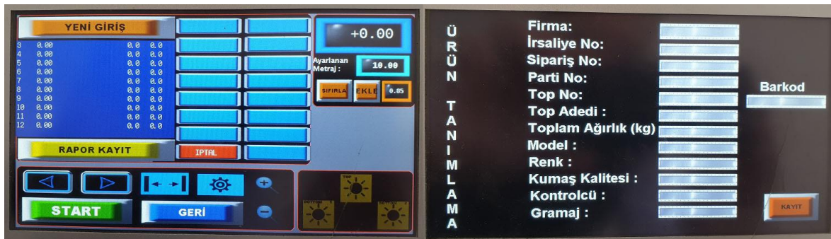
Şekil 1. Kumaş kontrol makinesi akıllı tablet giriş ve ürün tanımlama ekranları (eski sürüm) [1] (Fabric inspection machine smart tablet entry and product identification screens (old version) [1])
