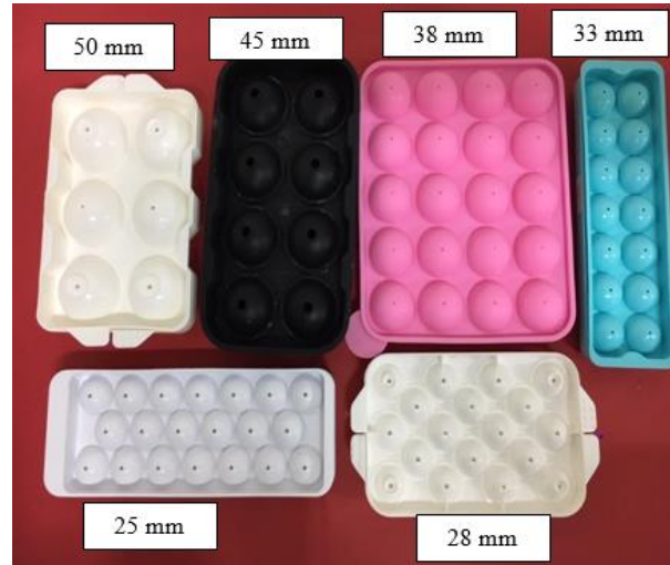
Şekil 1. Yapay dolu üretiminde kullanılan kalıplar (Molds used in the production of artificial hail)
