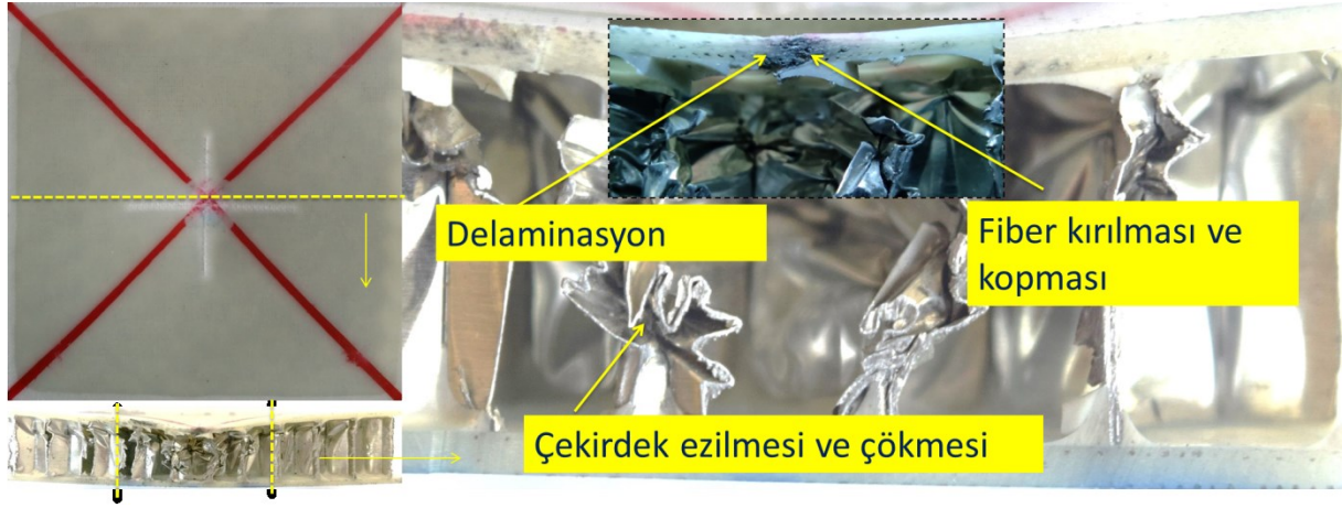
Şekil 8. Saf yapıştırıcılı numunenin üst yüzey ve kesit görüntüleri
