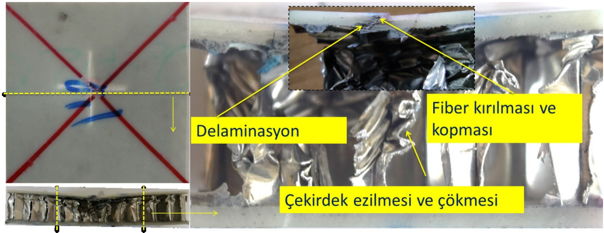
Şekil 9. %0,1 ÇCKNT katkılı numunenin üst yüzey ve kesit görüntüleri
