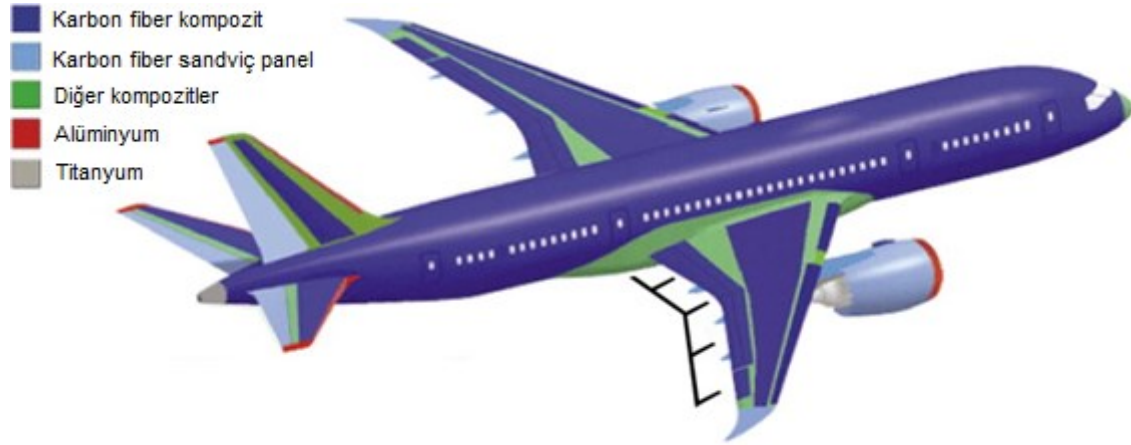
Şekil 1. Boeing Dreamliner-787 uçağının gövde, kanat ve kuyruk kısmında kullanılan malzemeler [8]
