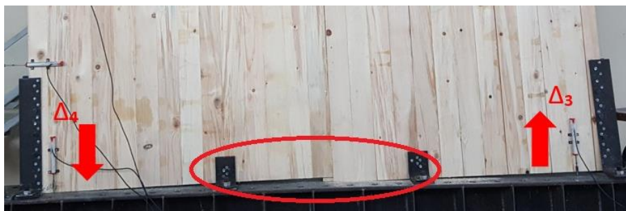
Şekil 3. CLT duvarların maksimum yükte meydana gelen deformasyonları
