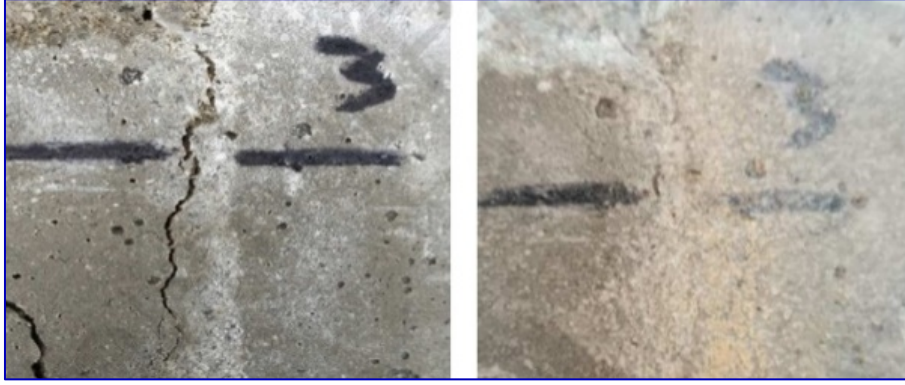
Şekil 9. Atık tuğla katkılı betonda gözlenen iyileşme (Saleem et al., 2021).
