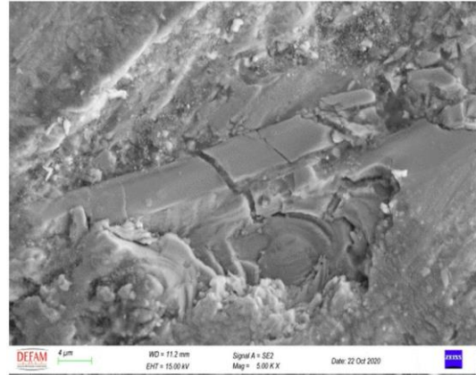
Şekil 11. 3FeMo-10FeV kaplamasında karbürlerin gevrek kırılması
