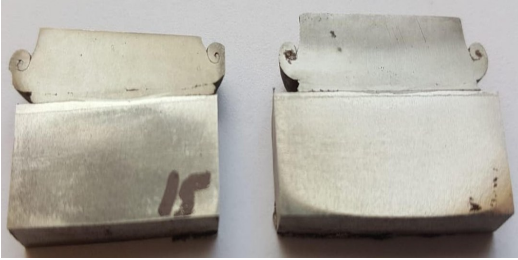
Şekil 2. Sürtünme karıştırma saplama kaynak eklemi makroyapı resmi
