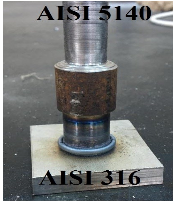
Şekil 1. Sürtünme karıştırma saplama kaynak eklemine makro görüntüsü
