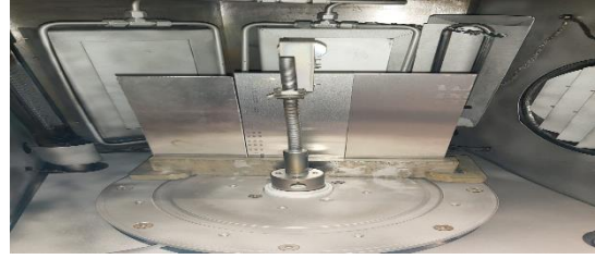
Şekil 2: BN Kaplama Makinasına Al numunelerin Yerleştirilmesi
