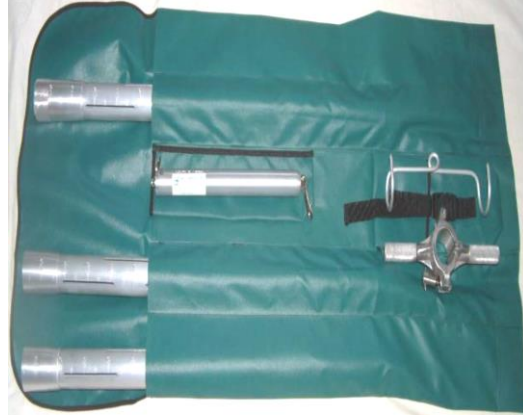
Şekil 3. DSİ rasatçıları tarafından manuel ölçümlerde kullanılan kar numune alma tüpü ve terazisi
