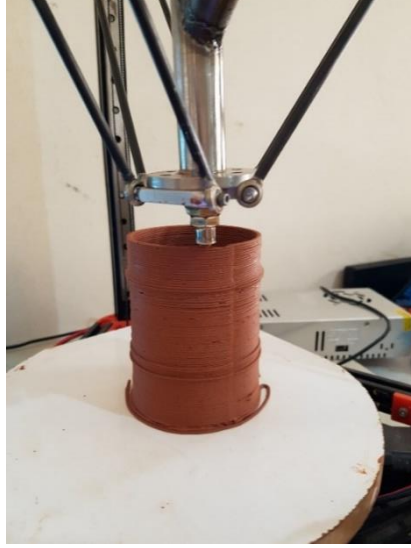
Görsel 19. Tasarımı tamamlanmış formların üç boyutu seramik yazıcı ile üretim aşaması.
