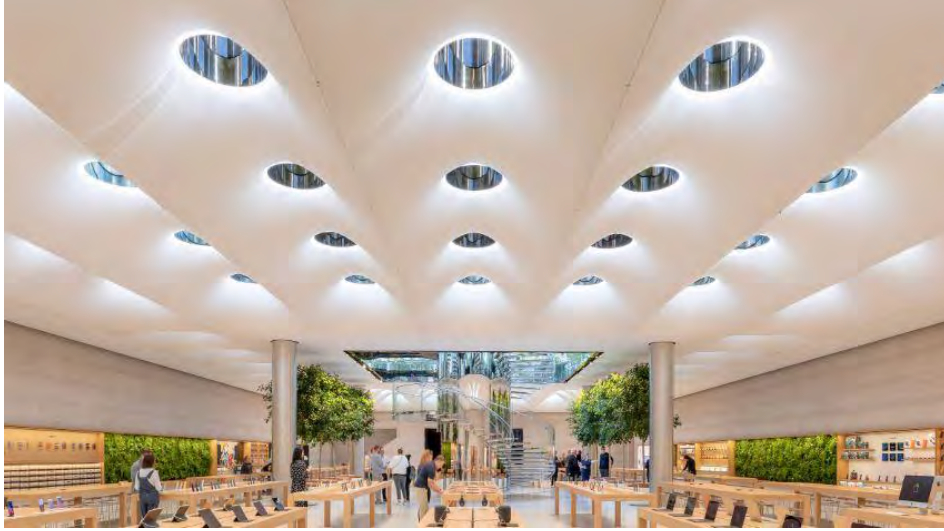
Şekil 12: Doğal ve yapay ışığı birleştiren kavisli kumaştan yapılmış arkadan aydınlatmalı, bulut benzeri tavan sistemi (URL-5)
