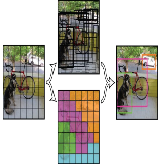
Şekil 4: Sınırlayıcı Kutular Aracılığıyla Nesne Tespiti
