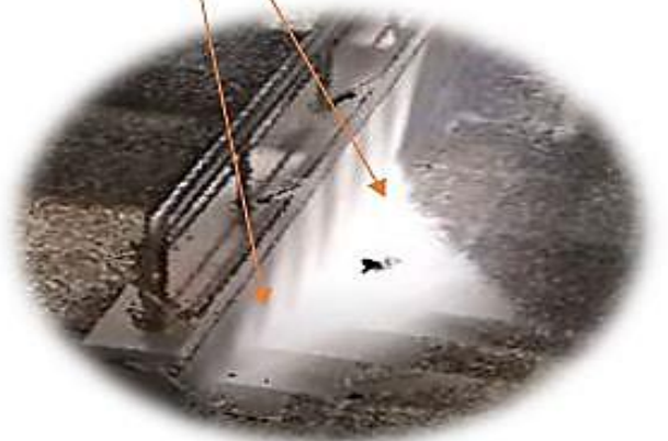
Şekil 9. Güneş ışınlarının yansımalarının nokta bulutuna etkisi
