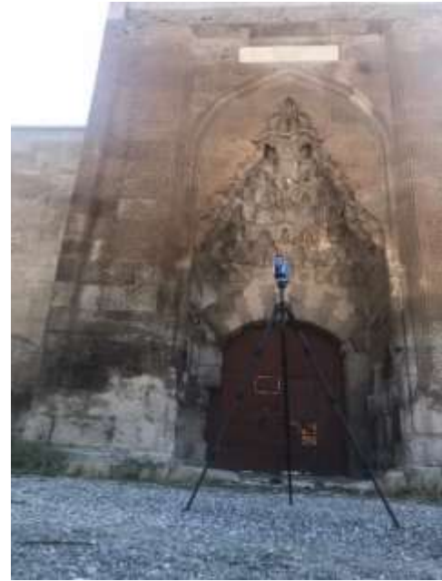
Şekil 8. Yersel lazer tarama işlemi (dış mekan)
