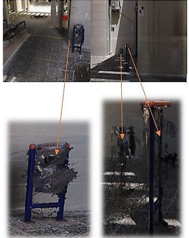
Şekil 11. Metalik, parlak yüzeylerde bozulmalar
