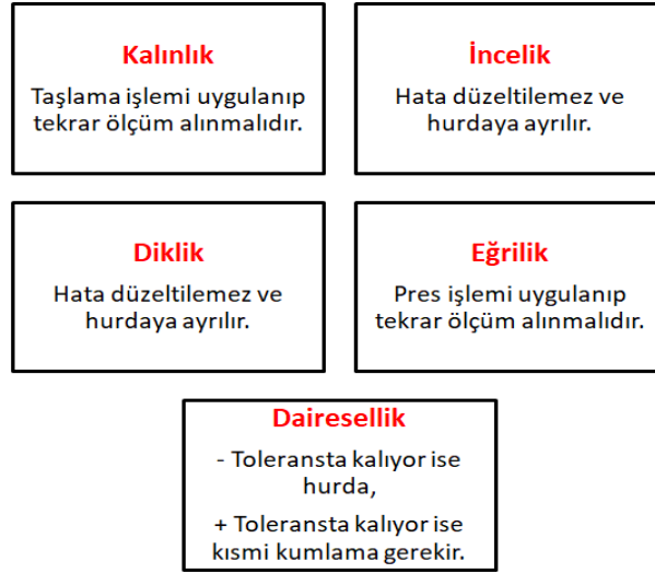
Şekil 5. Hata noktaları ve tolerans gösterimleri
