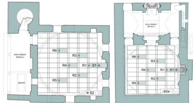
Şekil 8. Mescitlerin plan düzleminde kaynak-alıcı nokta konumları Solda Hoca Hasan Mescidi/ Sağda Taş Mescit [13]
