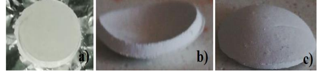
Şekil 5. Pelet haline getirilen CMAS tozlarının görüntüsü a) Sinterleme öncesi b) Sinterleme sonrası üst, c) Sinterleme sonrası alt elde edilen görüntü
