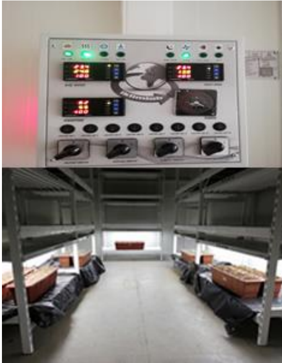
Şekil 1. Denemenin yapıldığı iklim odası kumanda panosunu dıştan görünümü
