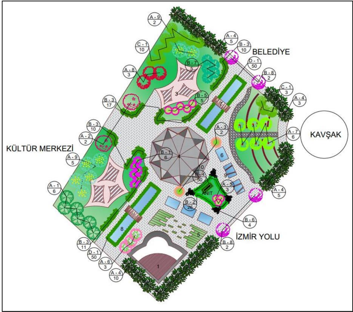
Şekil 10. Meydan tasarımının plan görüntüsü: Yapısal kullanımlar: 1-Kafe, 2-Oturma alanı, 3 ve 4-Germe çatılı yarı kapalı oturma alanı- sergi alanı, 5- Mevsimlik çiçek parterleri, 6- Akvaryum, 7- Köprü, 8- Mini su yüzeyi, 9- Sis duvarı, 10- Zemin led aydınlatması.
