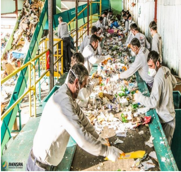
Resim 7. Sisteme giren ambalaj atıklarının ayrıştırılması işlemi
