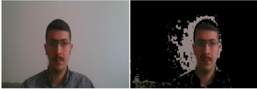
Şekil 6. Filtresiz görüntü (solda), Ten rengi filtresi uygulanan görüntü (sağda)
