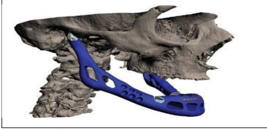
Resim-1: Üç boyutlu baskı tekniği ile üretilmiş çene implantı (Singare ve diğ., 2015).
