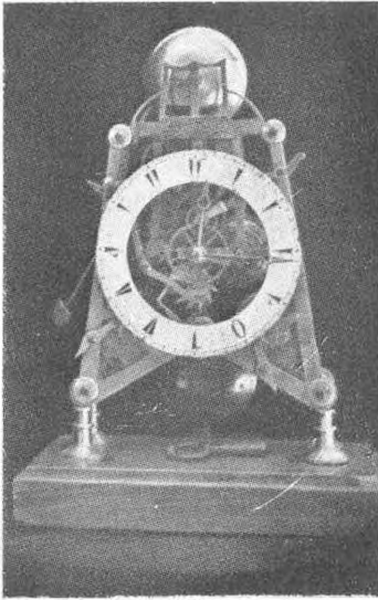
Res. 11 — En. No. 16/1517 Piriñten yapılmış olan bu saatin makine aksamı çok teferruatlı olup tamamen açıktır. Rakkaslı saat tiplerindedir. Üzerinde “Ameli esseyit elhac Mustafa Refik 1279-1862” imza ve tarihi vardır.
