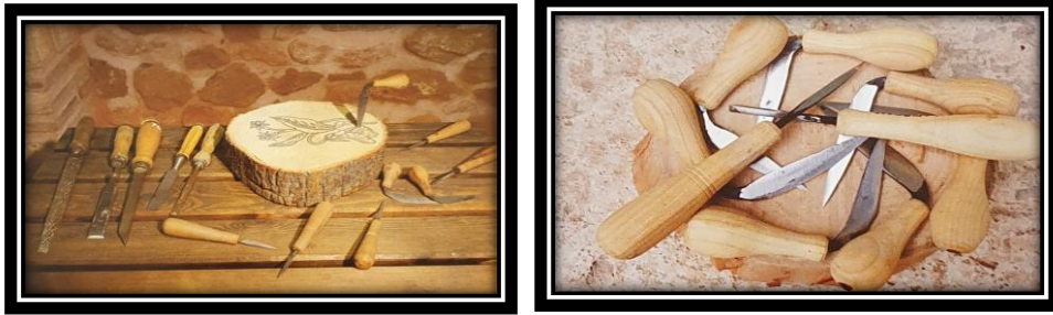
Fotoęraf 9: Aęa kalıp oyma bıakları ve izimi yapılmıŐ ihlamur aęacı, NakıŐbul bıaęı ve Iskarpelalar (Demirci, 2015: 60).
