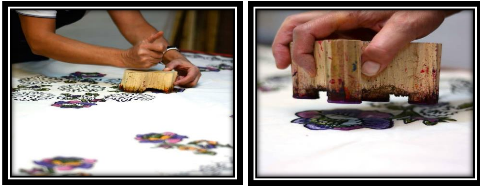
Fotođraf 15: Elvan kalıbı ile yazma işlemi, geleneksel baskı yazma kalıp ve oyma ustası Yasemin Ertařtan (Yasemin Sanat Evi 2018 Tokat).
