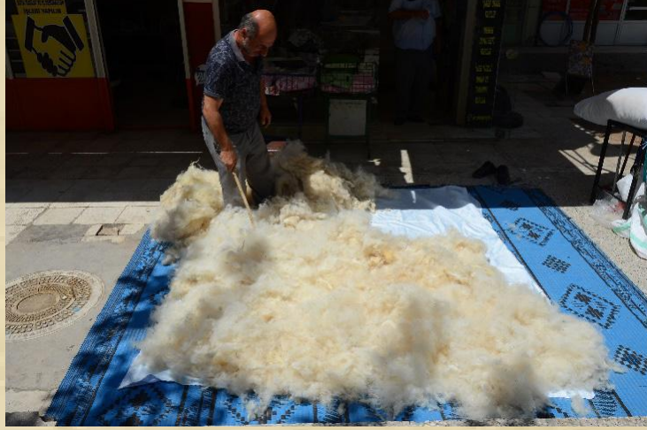
Görsel 8. Kılıfın serilmesi ve yünün yayılması
