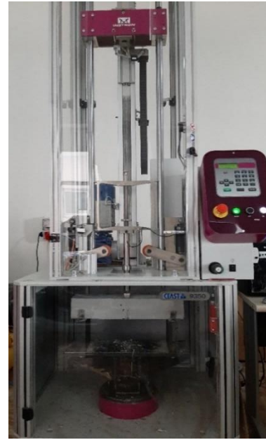
Şekil 2. Ağırlık düşürme deneyinde kullanılan aletli ağırlık düşürme test cihazı
