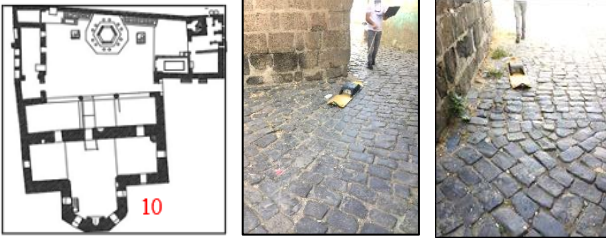
Şekil 22. Hoca Ahmet (Ayn Minare) Cami aks kayması bulunan harim güney duvarının bulunduğu sokak zemininde yapılan GPR 10 taramaları ve konumları
