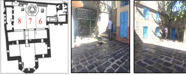
Şekil 18. Hoca Ahmet (Ayn Minare) camii avlu zemininde yapılan GPR 6- GPR 7- GPR 8 taramaları ve konumları
