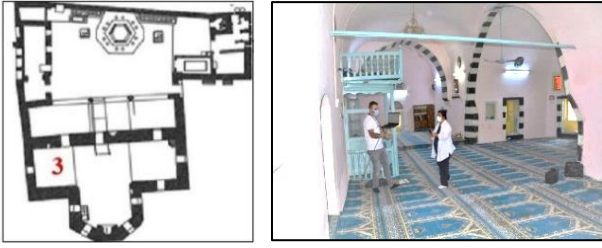
Şekil 14.Hoca Ahmet (Ayn Minare) Cami harimin batı bölümü zemindeki georadar (GPR) 3 taramaları ve konumları
