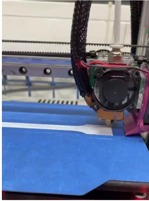
Şekil 1. Çalışmada kullanılan 3B yazıcı çekme numune imalat görüntüsü
