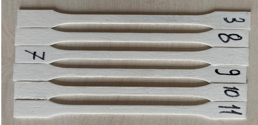
Şekil 2. Eklemeli imalat ile üretilen çekme test numunelerinin görüntüsü
