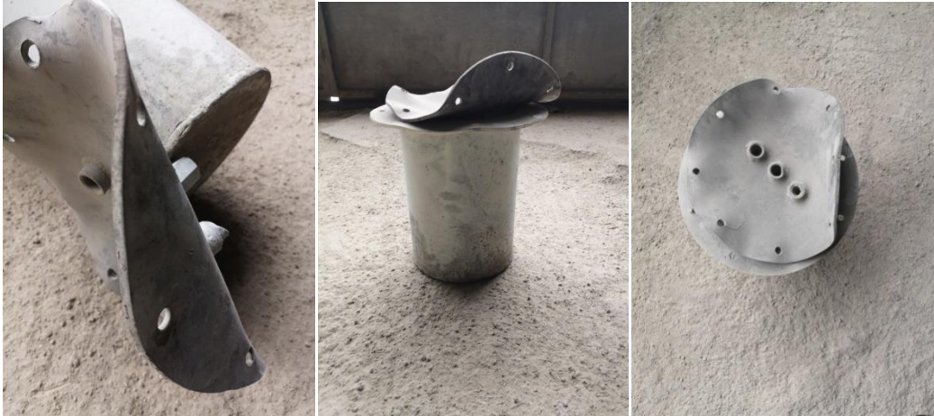
Şekil 3. Sahada Gözlemlenen Trimetil Borat Karıştırma Kabının Patlamadan Sonraki Görüntüsü
